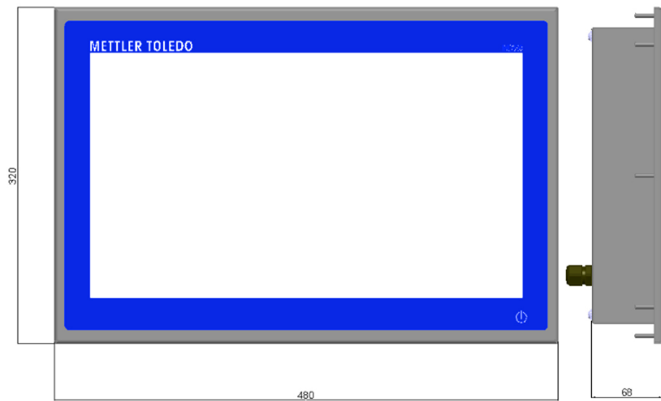
Figura 1-6: Dimensioni IND970-19-HMI integrabile in pannello di controllo
